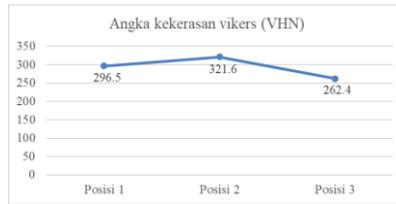
Angka kekerasan baja carbon 1045 sebelum proses perlakuan panas dengan beban penekanan 2000 gram dari data grafik kita mendapatkan nilai angka kekerasan vikers secara vertikal dan horizontal nilai titik 1 (atas) 296,5 nilai titik 2 (tengah) 321,6 dan titik 3 (bawah) 262,4. Angka rata-rata dari pengujian baja carbon steel 1045 sebelum perlakuan panas dengan nilai 293,5.
