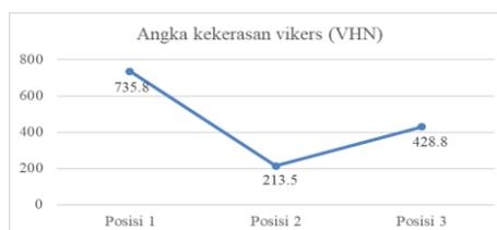
angka kekerasan baja carbon 1045 setelah proses perlakuan panas ( media air ) dengan beban penekanan 2000 gram dari data grafik kita mendapatkan nilai secara vertikal dan horizontal pada baja carbon 1045 setelah proses
